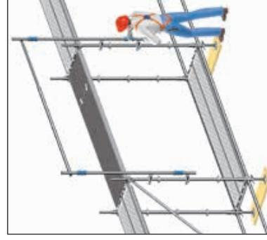
Afbeelding 19: Detail van de montage van de montageleuning bij niveauiwisseling
