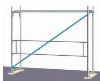
5d Doorlopende diagonaalmontage. Vanaf het onderste veld diagonalen doorlopend kruiselings over maximaal 9 velden monteren. Na ten hoogste 5 velden de diagonaalmontage opnieuw beginnen.
