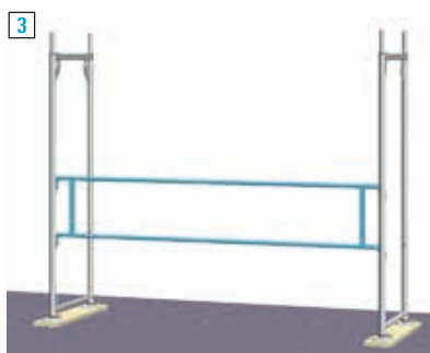
3 Stelramen direct met een enkele of dubbele leuning verbinden.
